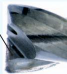
20m加工後も切りくず溶着および切りくず詰まりが見られず、切りくず排出性良好。
