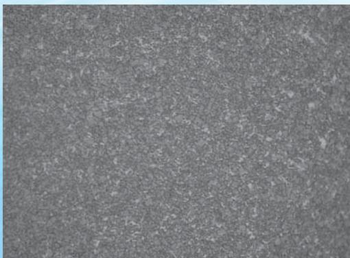
高硬度を維持しながら耐微小チップング性を向上させた合金です。紙などのスリッターや、極薄板打ち抜き等の、シャープエッジを必要とする分野に適しています。
