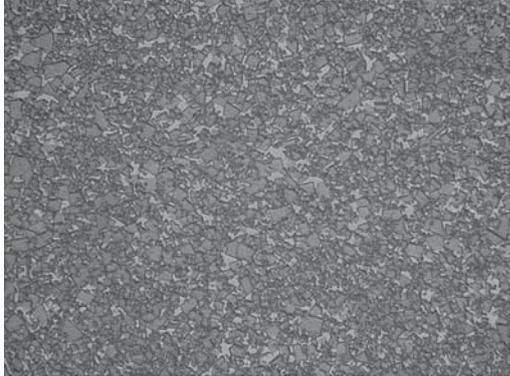
細粒子炭化物を用いた合金で、高硬度、高圧縮強度を備えています。また、NCシリーズは耐食性に優れています。
